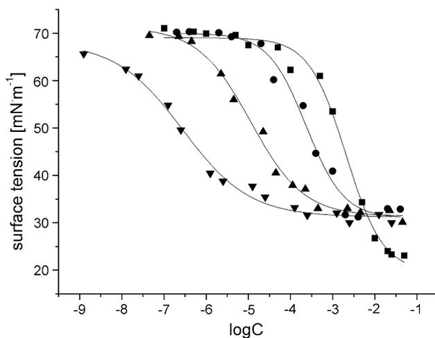
**Fig. 3** Surface tension isotherms for ■ P10S4, ● P12S4, ▲ P14S4, ▼ P16S4
